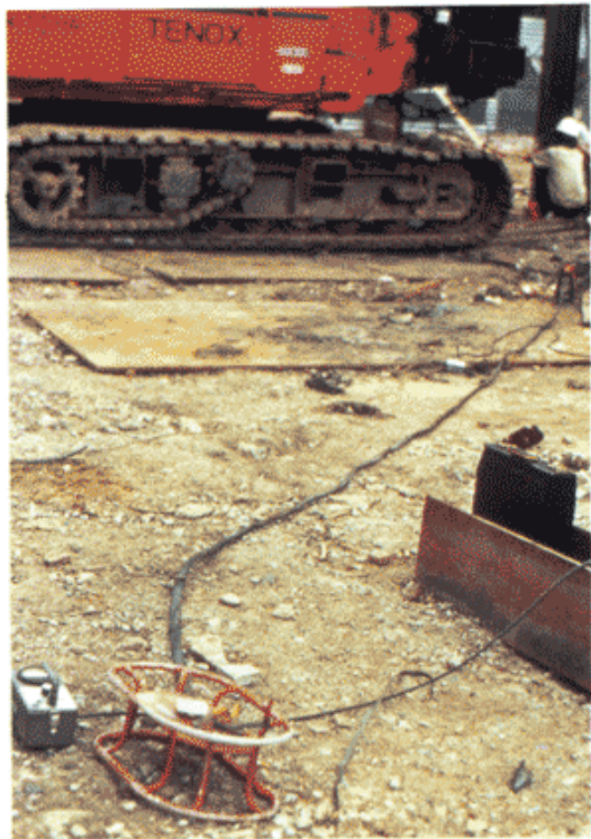
เจ้าหน้าที่กำลังติดฟิล์มเพื่อรับรังสี ในการตรวจสอบรอยเชื่อม
